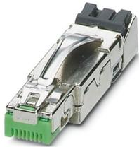
Connecteur RJ45, design: RJ45, indice de protection: IP20, nombre de pôles: 8, 1 Gbit/s, CAT5, matériau: Métal, type de raccordement: Raccordement autodénudant, section raccordable: AWG 26- 24, sortie du câble: droit, coloris: vert, Ethernet
