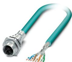
Connecteur d'appareil face arrière, Ethernet CAT6<sub>A</sub> (10 Gbit/s) CAT6<sub>A</sub>, 8-pôles, PUR, bleu lagon RAL 5021, blindé, connecteur femelle, droit, M12-SPEEDCONNEC, codage: X, sur extrémité libre, Montage face arrière, M16 x 1,5, Ligne de bus, longueur de câble: 5 m, Ethernet 10 GBit, Produit de remplacement selon RoHS II sans exception 6c (Pb < 0,1 %) référence : 1239449
