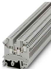
Blocs de jonction simple, tension nominale: 400 V, intensité nominale: 24 A, type de raccordement: Raccordement vissé, 1er étage, Section de référence: 2,5 mm<sup>2</sup>, section : 0,2 mm<sup>2</sup> - 2,5 mm<sup>2</sup>, type de montage: NS 35/7,5, NS 35/15, NS 32, coloris: gris
