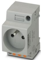
Prise de courant, Modèle d'enfichage de type E, pour la France et autres pays, avec protection étendue contre les contacts accidentels / obturateur, gris, pour montage sur profilé dans une interface de service ou pour montage direct, -20 °C, 60 °C, NF C61-314
