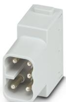
Module à élément de contact, nombre de pôles: 5, contacts de puissance: 5, contacts de commande: 0, Mâle, Raccordement Push-in, 400 V, 16 A, 0,14 mm<sup>2</sup> ... 2,5 mm<sup>2</sup>, application: Puissance
