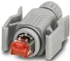
Connecteur RJ45, design: RJ45, indice de protection: IP67, nombre de pôles: 8, 1 Gbit/s, CAT6, matériau: Plastique, type de raccordement: Raccordement à sertir, section raccordable: AWG 27- 24, sortie du câble: droit, coloris: gris, Ethernet / PROFINET
