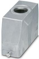
Capot passe-câble B24, pour étrier longitudinal, matériau: Aluminium coulé sous pression, résistant à l'eau de mer, nombre de sorties: 1, droit, 1x Pg21, hauteur: 76 mm, presse-étoupe: sans, Standard
