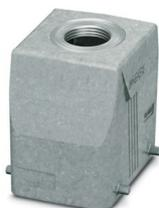
Capot passe-câble D50, pour étrier transversal, matériau: Aluminium coulé sous pression, résistant à l'eau de mer, nombre de sorties: 1, droit, 1x Pg21, hauteur: 80 mm, presse-étoupe: Pg21, Standard
