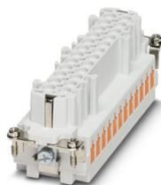
Élément de contact, nombre de pôles: 24+PE, taille: B24, nombre de raccordements par pôle: 1, Connecteur femelle, Raccordement QUICKON, 500 V, 16 A, 0,34 mm<sup>2</sup> ... 2,5 mm<sup>2</sup>
