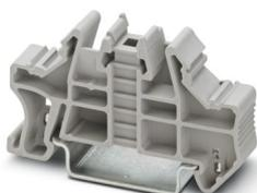
Butée à montage rapide, pour rail DIN NS 35/7,5 ou NS 35/15, avec possibilité de repérage, largeur : 9,5 mm, coloris : gris
