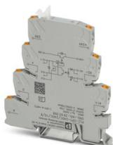
PLC-INTERFACE avec contact de retour, comprenant un module de base avec raccordement Push-in et relais à semi-conducteurs miniature intégré, pour montage sur profilé NS 35/7,5, 1 contact NO, entrée : 24 V DC, sortie : 3-33 V DC/10 A
