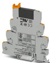
PLC-INTERFACE pour fonctions de sortie, comprenant un module de base PLC-BPT.../ACT avec raccordement Push-in et relais à semi-conducteurs miniature enfichable, pour montage sur profilé NS 35/7,5, 1 contact NO, entrée : 24 V DC, sortie : 3-33 V DC/3 A
