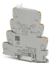
PLC-INTERFACE avec contact inverseur électronique, comprenant un module de base PLC-BPT.../21 avec raccordement Push-in et relais à semi-conducteurs miniature intégré, pour montage sur profilé NS 35/7,5, 1 contact inverseur, entrée : 24 V DC, sortie : 3-48 V DC/500 mA
