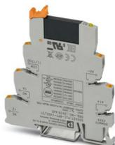
Interface PLC, comprenant le module de base PLC-BPT.../21 avec raccordement Push-in et relais à semi-conducteurs miniature enfichable, pour montage sur profilé NS 35/7,5, 1 contact NO, entrée : 24 V DC, sortie : 3-33 V DC/3 A
