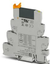
PLC-INTERFACE, comprenant un module de base PLC-BSC.../21 avec raccordement vissé et relais à semi-conducteurs miniature enfichable, pour montage sur profilé NS 35/7,5, 1 contact NO, entrée : 24 V DC, sortie : 3-33 V DC/3 A
