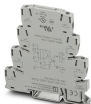
PLC-INTERFACE avec contact inverseur électronique, comprenant un bloc de jonction de base PLC-BSC.../21 avec raccordement vissé et relais statique miniature intégré, pour le montage sur rail DIN NS 35/7,5, 1 contact inverseur, entrée : 24 V DC, sortie : 3 V DC ... 48 V DC/500 mA
