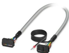
Câble rond blindé préconfectionné; raccordement 1 : IDC/FLK connecteur femelle (1x 14-pôles); raccordement 2 : IDC/FLK connecteur femelle (1x 14-pôles) (La tresse de blindage sort d'une extrémité de câble distincte.); longueur de câble: 1,8 m
