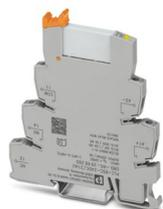
PLC-INTERFACE, comprenant un module de base PLC-BSC.../21 avec raccordement vissé et relais miniature enfichable à contact doré multicouche, pour montage sur profilé NS 35/7,5, 1 contact inverseur, tension d'entrée 24 V DC
