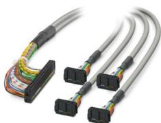
Câble rond pré-équipé; raccordement 1 : IDC/FLK connecteur femelle (1x 50-pôles); raccordement 2 : IDC/FLK connecteur femelle (4x 14-pôles); longueur de câble: 2 m
