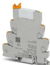
PLC-INTERFACE, comprenant le module de base PLC-BPT.../21 avec raccordement Push-in et un relais miniature enfichable avec contact de puissance, pour montage sur profilé NS 35/7,5, 1 contact inverseur, tension d'entrée 24 V DC
