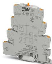
PLC-INTERFACE avec commutateur (utilis. manuelle) pour fonctions « manuel, 0 et automatique », avec raccordement Push-in et relais à contact de puissance intégré, montage sur profilé NS 35/7,5, 1 contact NO, tension entrée 24 V AC/DC
