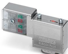
Connecteur D-SUB, 9 pôles, mâle, sortie du câble à 90°, système de bus : PROFIBUS-DP jusqu'à 12 Mbit/s, résistance de terminaison activable via commutateur coulissant, schéma des pôles : 3, 5, 6, 8 ; raccordement IDC
