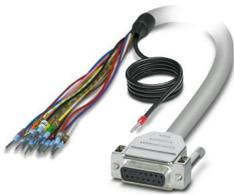
Câble rond blindé préconfectionné; raccordement 1 : Fils individuels (15-pôles) (Les fils sont repérés et équipés d'embouts. La tresse de blindage sort d'une extrémité de câble distincte.); raccordement 2 : Connecteur femelle D-SUB (1x 15-pôles); longueur de câble: 4 m
