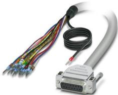
Câble rond blindé préconfectionné; raccordement 1 : Fils individuels (15-pôles) (Les fils sont repérés et équipés d'embouts. La tresse de blindage sort d'une extrémité de câble distincte.); raccordement 2 : Connecteur femelle D-SUB (1x 15-pôles); longueur de câble: 3 m
