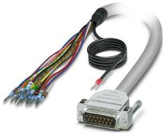
Câble rond blindé préconfectionné; raccordement 1 : Fils individuels (15-pôles) (Les fils sont repérés et équipés d'embouts. La tresse de blindage sort d'une extrémité de câble distincte.); raccordement 2 : Connecteur mâle D-SUB (1x 15-pôles); longueur de câble: 6 m
