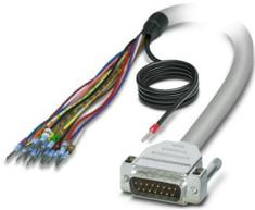
Câble rond blindé préconfectionné; raccordement 1 : Fils individuels (15-pôles) (Les fils sont repérés et équipés d'embouts. La tresse de blindage sort d'une extrémité de câble distincte.); raccordement 2 : Connecteur mâle D-SUB (1x 15-pôles); longueur de câble: 4 m
