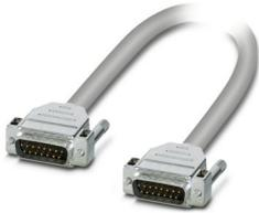
Câble rond prééquipé, blindé, exempt d'halogène; raccordement 1 : Connecteur mâle D-SUB (1x 15-pôles); raccordement 2 : Connecteur mâle D-SUB (1x 15-pôles); longueur de câble: 2 m
