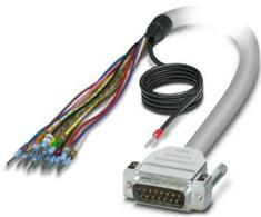
Câble rond blindé préconfectionné; raccordement 1 : Fils individuels (15-pôles) (Les fils sont repérés et équipés d'embouts. La tresse de blindage sort d'une extrémité de câble distincte.); raccordement 2 : Connecteur mâle D-SUB (1x 15-pôles); longueur de câble: 2 m
