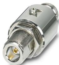
Barrière d'antenne pour traversée de paroi, mode de protection : Ex i, indice de protection : IP65, installation du dispositif de protection séparatif : zones 2/22, installation de l'antenne : en atmosphère explosible poussière et gaz, plage de fréquence : 0,3 GHz ... 6 GHz, raccordement : 2 x N (femelle), homologation ATEX et IECEx
