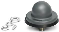
Antenne omnidirectionnelle multibande avec protection anti-vandalisme pour le montage sur les armoires électriques, bande de fréquences : 2,4 GHz / 5 GHz / 6 GHz, gain : 6 dBi / 8 dBi / 8 dBi, indice de protection : IP68, résistance aux chocs : IK08, résistant aux produits de nettoyage, aux chocs et aux vibrations, raccordement : N (femelle)
