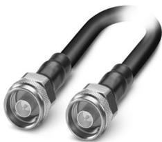
Câble coaxial 50  $\Omega$ , longueur : 5 m, N(m) - N(m), diamètre extérieur du câble : 10,3 mm, fréquence de transmission :  $\leq$  7,25 GHz, atténuation typique : 800 MHz 0,8 dB, 2,4 GHz 1,4 dB, 5,8 GHz 2,2 dB, 7,25 GHz 2,5 dB
