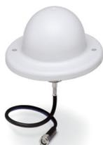
Antenne omnidirectionnelle avec protection anti-vandalisme pour le montage sur une armoire électrique, bande de fréquences : 2,4 GHz, gain : 3 dBi, indice de protection : IP55, résistance aux chocs : IK08, raccordement : RSMA (mâle), avec câble de raccordement de 1,5 m
