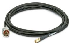
Câble d'antenne, diamètre extérieur : 5 mm, conducteur interne : rigide, atténuation : 0,4 / 0,5 / 0,6 dB à 0,9 / 2,4 / 5,8 GHz, raccordement : N (mâle) -> RSMA (mâle), longueur de câble : 0,5 m
