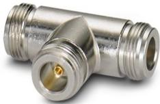
Séparateur d'antennes, plage de fréquences : 0,3 GHz ... 6 GHz, indice de protection : IP65, raccordement : 3 x N (femelle), câble de raccordement adapté au raccordement d'antenne (référence 2700677)
