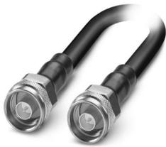
Câble coaxial 50  $\Omega$ , longueur : 10 m, N(m) - N(m), diamètre extérieur du câble : 10,3 mm, fréquence de transmission :  $\leq$  7,25 GHz, atténuation typique : 800 MHz 1,6 dB, 2,4 GHz 2,7 dB, 5,8 GHz 4,3 dB, 7,25 GHz 5 dB
