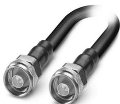
Câble coaxial 50  $\Omega$ , longueur : 30 m, N(m) - N(m), diamètre extérieur du câble : 10,3 mm, fréquence de transmission :  $\leq$  7,25 GHz, atténuation typique : 800 MHz 4,8 dB, 2,4 GHz 8,1 dB, 5,8 GHz 12,9 dB, 7,25 GHz 15 dB
