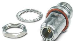
Adaptateur d'antenne pour la traversée pour armoire électrique, plage de fréquence : 0,3 GHz ... 6 GHz, indice de protection : IP65, raccordement : 2 x N (femelle)
