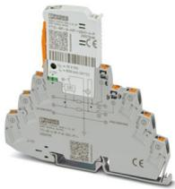
Parafoudre basse tension comprenant une fiche de protection et un élément de base, à indicateur d'état intégré et sectionnement par couteau pour trois fils de signaux à potentiel de référence commun. Pour applications HF et interfaces de télécommunication sans tension d'alimentation. Mise à la terre indirecte par éclateur à gaz, homologation EX e pour zone 2. Utilisable dans les circuits sécurisés jusqu'à SIL 3.
