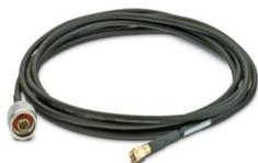
Câble d'antenne, diamètre extérieur : 5 mm, conducteur interne : rigide, atténuation : 0,5 / 0,8 / 1,1 dB à 0,9 / 2,4 / 5,8 GHz, raccordement : N (mâle) -> RSMA (mâle), longueur de câble : 1 m
