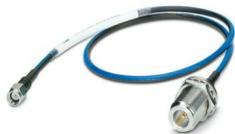
Câble d'antenne pour traversée pour armoire électrique, diamètre : 3,2 mm, conducteur interne : flexible, atténuation : 0,6 / 0,9 / 1,4 dB à 0,9 / 2,4 / 5,8 GHz, raccordement : N (femelle) -> RSMA (mâle), longueur de câble : 0,5 m
