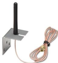
Antenne omnidirectionnelle pour montage mural, bande de fréquence : 2,4 GHz, gain : 2 dBi, indice de protection : IP65, raccordement : RSMA (mâle), avec câble de raccordement de 1,5 m, étrier de montage et accessoires de montage
