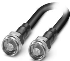
Câble coaxial 50  $\Omega$ , longueur : 15 m, N(m) - N(m), diamètre extérieur du câble : 10,3 mm, fréquence de transmission :  $\leq$  7,25 GHz, atténuation typique : 800 MHz 2,4 dB, 2,4 GHz 4,1 dB, 5,8 GHz 6,5 dB, 7,25 GHz 7,5 dB
