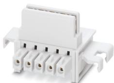
Connecteurs sur profilé, coloris: gris clair, intensité nominale: 8 A (contacts parallèles), tension de référence (III/2): 125 V, nombre de pôles: 5, gamme d'articles: TBUS5-17,5..., pas: 3,81 mm, montage: Montage sur profilé, verrouillage: sans, type de fixation: sans, type de conditionnement: emballé dans un carton, Article avec contacts dorés, connecteur de bus pour le raccordement de boîtiers électroniques, 5 contacts parallèles
