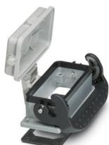
Embase HEAVYCONNEX B16, avec verrouillage longitudinal, hauteur 29 mm, avec couvercle synthétique, avec joint plat
