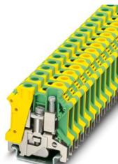
Bloc de jonction pour conducteur de protection, nombre de connexions: 2, type de raccordement: Raccordement vissé, Section de référence: 10 mm<sup>2</sup>, section : 0,5 mm<sup>2</sup> - 16 mm<sup>2</sup>, type de fixation: Pied PE avec vis de fixation, M4, type de montage: NS 35/7,5, NS 35/15, NS 32, coloris: vert/jaune
