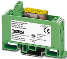
Relais de couplage sécurisé avec contacts à guidage forcé, 2 contacts inverseurs, une borne à vis fixe à 1 canal, largeur : 17,5 mm
