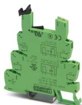
Module de base PLC de 6,2 mm pour fonctions de sortie avec raccordement à ressort, sans relais ni relais à semi-conducteurs, pour montage sur profilé NS 35/7,5, avec raccordement pour conducteur de retour (BB), 1 contact NO, tension d'entrée 5 V DC
