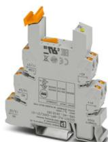
Module de base PLC de 14 mm avec raccordement Push-in, sans relais ni relais à semi-conducteurs, pour montage sur profilé NS 35/7,5, 2 contacts inverseurs, tension d'entrée : 24 V DC
