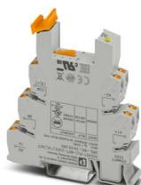
Module de base PLC de 14 mm pour courants d'enclenchement élevés avec raccordement Push-in, sans relais ni relais à semi-conducteurs, pour montage sur profilé NS 35/7,5, avec raccordement pour conducteur de retour (BB), 1 contact NO, tension d'entrée 24 V DC
