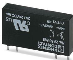
Relais à semi-conducteurs miniature enfichable, relais de puissance à semi-conducteurs, 1 contact NO, entrée : 24 V DC, sortie : 3 ... 33 V DC/3 A
