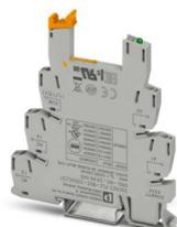
Module de base PLC de 6,2 mm pour courants permanents élevés avec raccordement vissé, sans relais ni relais à semi-conducteurs, pour montage sur profilé NS 35/7,5, 1 contact inverseur, tension d'entrée 230 V /ACDC
