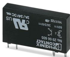
Relais à semi-conducteurs miniature enfichable, relais de puissance à semi-conducteurs, 1 contact NO, entrée : 60 V DC, sortie : 3 ... 33 V DC/3 A
