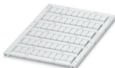
Repères pour blocs de jonction, à commander : sous forme de plaque, blanc, impression selon les indications du client, type de montage: encliquetage dans la rainure de repérage élevée, pour bloc de jonction au pas de : 6,2 mm, surface utile: 5,6 x 10,5 mm, Nombre d'étiquettes: 60
