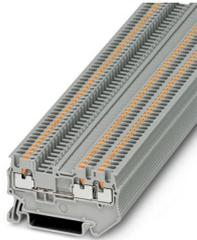
Blocs de jonction simple, tension nominale: 500 V, intensité nominale: 17,5 A, nombre de connexions: 3, type de raccordement: Raccordement Push-in, 1er étage, Section de référence: 1,5 mm<sup>2</sup>, section : 0,14 mm<sup>2</sup> - 1,5 mm<sup>2</sup>, type de montage: NS 35/7,5, NS 35/15, coloris: gris
