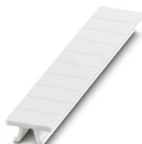
Ruban de repérage ZB, Rubans, blanc, vierge, repérable avec : PLOTMARK, CMS-P1-PLOTTER, type de montage: encliquetage, pour bloc de jonction au pas de : 5,2 mm, surface utile: 5,1 x 10,5 mm, Nombre d'étiquettes: 10
