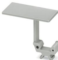
Étiquette de repérage de groupes de bloc de jonction, s'encliquette au centre des blocs de jonction à vis, à ressort ou pour raccordement rapide, repérage avec une étiquette 25 x 12 mm ou manuellement à l'aide du stylo B-STIFT, au niveau du pied avec ZB 5
