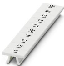
Ruban de repérage ZB, Rubans, blanc, repéré, longitudinal: L1, L2, L3, N, PE, L1, L2, L3, N, PE, type de montage: encliquetage, pour bloc de jonction au pas de : 5,2 mm, surface utile: 5,15 x 10,5 mm, Nombre d'étiquettes: 10
