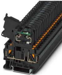
Bloc de jonction-fusibles, type de fusible: Verre / Céramique / ..., type de fusible: G / 5 x 20, tension nominale: 24 V, intensité nominale: 6,3 A, nombre de pôles: 1, type de raccordement: Raccordement Push-in, Section de référence: 4 mm<sup>2</sup>, section : 0,2 mm<sup>2</sup>- 6 mm<sup>2</sup>, type de montage: NS 35/7,5, NS 35/15, coloris: noir
