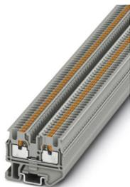
Mini bloc de jonction de traversée, tension nominale: 500 V, intensité nominale: 17,5 A, type de raccordement: Raccordement Push-in, 1er étage, Section de référence: 1,5 mm<sup>2</sup>, section : 0,14 mm<sup>2</sup> - 1,5 mm<sup>2</sup>, type de montage: NS 15, coloris: gris
