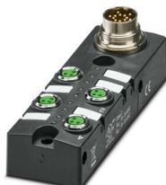
Répartiteur pour capteurs/actionneurs, application : Standard, type de raccordement: Connecteur femelle M8 Métal, nombre de prises: 4, nombre de pôles: 3, détrompage: A - standard, affectation des prises: simple, affichage d'état: Oui, pnp; racc. câble multicond.: Raccordement enfichable M16 90°, blindage: non
