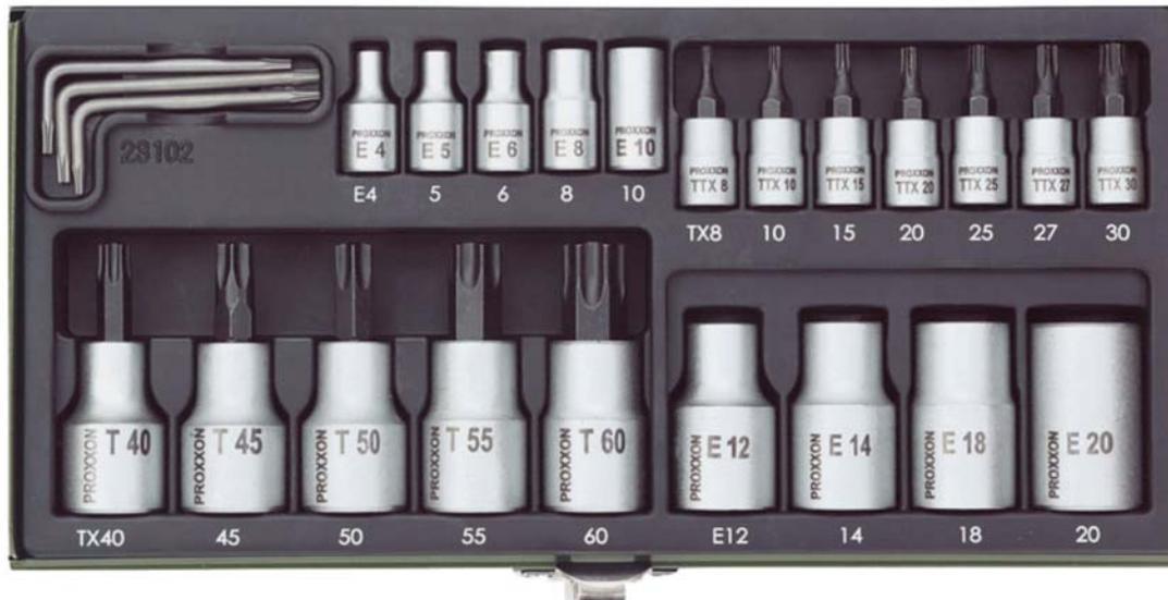
Embouts de vissage TX à entraînement 1/4" (6,3 mm) de TX 8 à TX 30 (troué) et douilles TX de E4 à E10 (toutes avec un couple de serrage jusqu'à 25 Nm). Avec entraînement 1/2" (12,5 mm) de TX 40 à 60 et douilles TX E12 à E20 (pour un couple de serrage de 25 à 135 Nm). 3 clés coudées TX 6, 8 et 10. Composition selon illustration.
