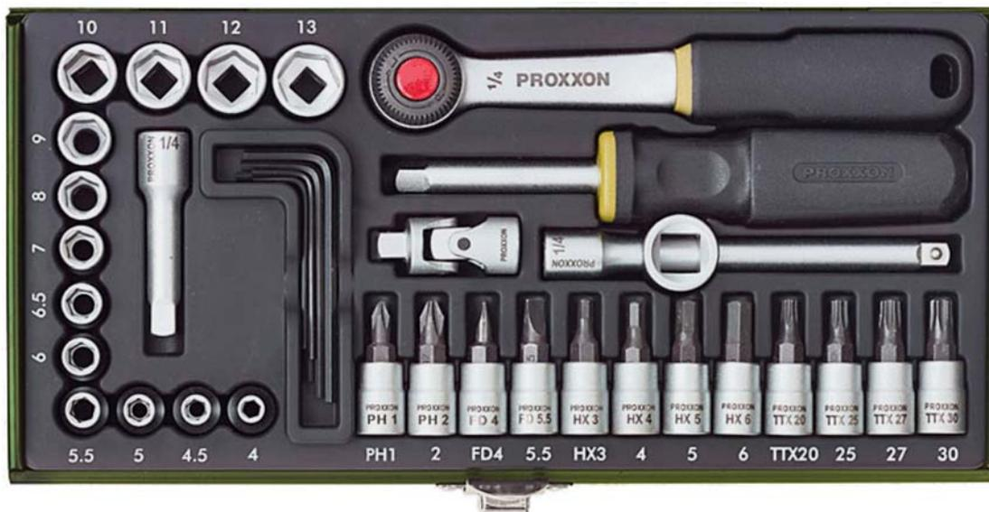
Douilles de 4 à 13 mm. Embouts de vissage à entraînement 4 pans pour vis à fentes, vis à empreinte cruciforme, vis TX et vis à 6 pans creux. En outre, 5 clés coudées pour vis à 6 pans creux en 1,25 - 1,5 - 2 - 2,5 et 3 mm. Composition selon illustration.
