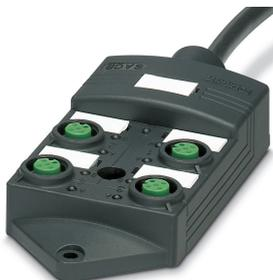
Répartiteur pour capteurs/actionneurs, application : Standard, type de raccordement: Connecteur femelle M12 SPEEDCONNEC Plastique, nombre de prises: 4, nombre de pôles: 5, détrompage: A - standard, affectation des prises: double, affichage d'état: Oui, pnp; racc. câble multicond.: Connexion fixe 180°, PUR/PVC, longueur du câble: 20 m, blindage: non
