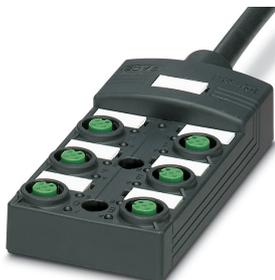
Répartiteur pour capteurs/actionneurs, application : Standard, nombre de prises: 6, nombre de pôles: 5, détrompage: A - standard, affectation des prises: double, affichage d'état: Oui, pnp; racc. câble multicond.: Connexion fixe 180°, PUR/PVC, longueur du câble: 20 m, blindage: non
