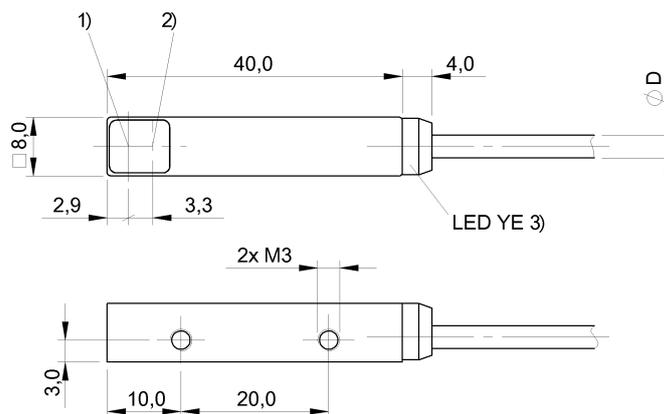
1) Axe optique émetteur, 2) Axe optique récepteur, 3) Fonction de sortie
