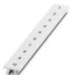
Repérage ZB, Rubans, blanc, repéré, repérable avec : CMS-P1-PLOTTER, type de montage: encliquetage dans la rainure de repérage élevée, pour bloc de jonction au pas de : 8,3 mm, surface utile: 10,5 x 8,3 mm
