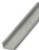
Profilé plein, Profil standard, largeur: 35 mm, hauteur: 7,5 mm, selon EN 60715, matériau: Acier, galvanisé, traité par passivation couche épaisse, longueur: 2000 mm, coloris: argenté
