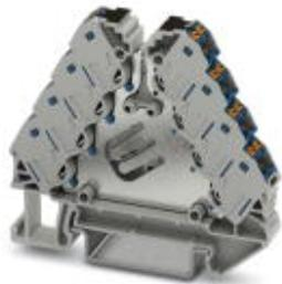
Distributeurs de potentiel, tension nominale: 250 V, intensité nominale: 17,5 A, section : 0,14 mm<sup>2</sup> - 2,5 mm<sup>2</sup>, AWG: 14 - 26, type de raccordement: Raccordement Push-in, nombre de pôles: 2, nombre de connexions: 16, largeur: 8,3 mm, longueur: 64 mm, coloris: gris, couleur des éléments de raccordement: bleu, montage: NS 35/7,5, NS 35/15
