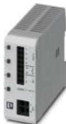
Disjoncteur d'appareil électronique multicanaux, avec limitation de courant active pour la protection de quatre consommateurs à 24 V DC en cas de surcharge et de court-circuit. Avec dispositif de verrouillage électronique des intensités nominales réglées. Pour une installation sur des rails DIN.
