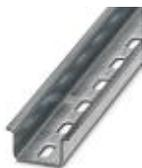
Profilé percé, Profil standard, largeur: 35 mm, hauteur: 15 mm, similaire à EN 60715 : 2001, matériau: Acier, galvanisé, longueur: 2000 mm, coloris: argenté
