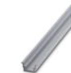
Profilé plein, Profil standard, largeur: 35 mm, hauteur: 15 mm, similaire à EN 60715 : 2001, matériau: Aluminium, aucun revêtement, longueur: 2000 mm, coloris: argenté
