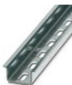
Profilé percé, Profil standard, largeur: 35 mm, hauteur: 15 mm, similaire à EN 60715 : 2001, matériau: Acier, galvanisé, passivation blanche, longueur: 2000 mm, coloris: blanc
