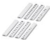
Repérage ZB, plat, à commander : par bandes, blanc, impression selon les indications du client, type de montage: encliquetage dans la rainure de repérage plate, pour bloc de jonction au pas de : 3,5 mm, surface utile: 3,5 x 5,2 mm
