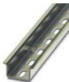
Profilé percé, Profil standard, largeur: 35 mm, hauteur: 15 mm, similaire à EN 60715 : 2001, matériau: Acier, galvanisé, traité par passivation couche épaisse, longueur: 2000 mm, coloris: argenté
