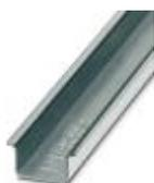
Profilé plein, Profil standard, largeur: 35 mm, hauteur: 15 mm, similaire à EN 60715 : 2001, matériau: Acier, galvanisé, passivation blanche, longueur: 2000 mm, coloris: blanc
