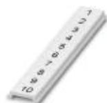
Repérage ZB, plat, Rubans, blanc, repéré, impression transversale: numérotation continue 1-10, 11-20, etc. jusqu'à 91-100, type de montage: encliquetage dans la rainure de repérage plate, pour bloc de jonction au pas de : 3,5 mm, surface utile: 5,15 x 3,5 mm
