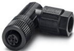
Connecteur, 5-pôles, Connecteur femelle coudé M12, détrompage A, Raccordement Push-in, matériau de la molette: Plastique, diamètre extérieur du câble 4 mm ... 8 mm
