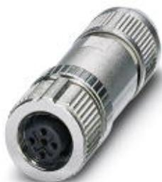
Connecteur-bus, PROFIBUS DP (12 Mbit/s), 2-pôles, blindé, Connecteur femelle droite M12, Détrompage B, Raccordement Push-in, matériau de la molette: Zinc moulé sous pression, nickelé, diamètre extérieur du câble 4 mm ... 8 mm
