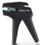
Outil à dénuder, pour conducteurs et câbles de 0,08 à 2,5 mm de section, réglage automatique, longueur à dénuder réglable jusqu'à 15 mm, capacité de sectionnement jusqu'à 6 mm<sup>2</sup> souple /1,5 mm<sup>2</sup> rigide
