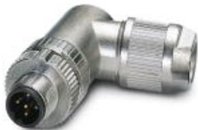
Connecteur-bus, INTERBUS (500 kbit/s), 5-pôles, blindé, Connecteur coudé M12, Détrompage B, Raccordement Push-in, matériau de la molette: Zinc moulé sous pression, nickelé, diamètre extérieur du câble 4 mm ... 8 mm
