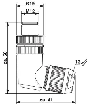
Connecteur mâle M12 SPEEDCONNEC coudé, blindé
