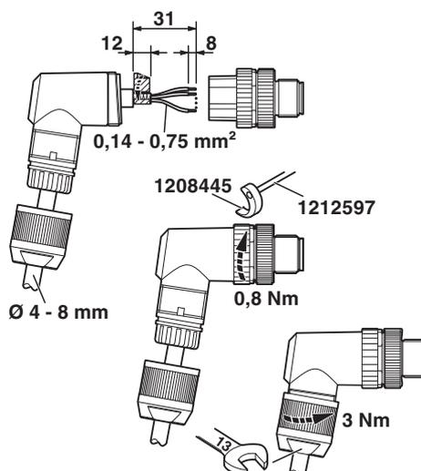
Glisser les écrous de pression et les capots passe-câble sur le câble, dénuder ce dernier, raccourcir le blindage, dénuder les fils, raccorder ces derniers, les torsader légèrement ensemble en cas de capot passe-câble droit, coller le film de blindage autour du blindage raccourci, coller un autre film de blindage autour du paquet de fils en cas de diamètre extérieur de câble < 6 mm, visser le capot passe-câble avec l'isolant mâle, visser fermement l'écrou de pression.
