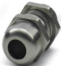
Presse-étoupe, Matériau raccordement vissé: Acier inoxydable 1.4305, Diamètre extérieur du câble 3 mm ... 6,5 mm, Blindage: non, Filetage de raccordement: M12, Coloris: argenté
