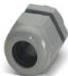
Presse-étoupe, Matériau raccordement vissé: PA, Diamètre extérieur du câble 5 mm ... 10 mm, Blindage: non, Filetage de raccordement: Pg11, Coloris: gris argent RAL 7001
