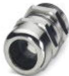
Presse-étoupe, Matériau raccordement vissé: laiton, nickelé, Diamètre extérieur du câble 5 mm ... 10 mm, Blindage: oui, Filetage de raccordement: Pg11, Coloris: argenté
