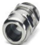
Presse-étoupe, Matériau raccordement vissé: laiton, nickelé, Diamètre extérieur du câble 5 mm ... 10 mm, Blindage: non, Filetage de raccordement: Pg11, Coloris: argenté
