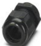
Presse-étoupe, Matériau raccordement vissé: PA, Diamètre extérieur du câble 5 mm ... 10 mm, Blindage: non, Filetage de raccordement: Pg11, Coloris: noir foncé RAL 9005
