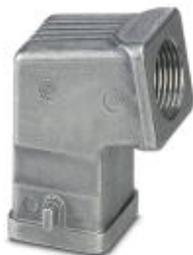
Capot passe-câble D7, pour étrier longitudinal, Matériau: Aluminium coulé sous pression, résistant à l'eau de mer, Nombre de sorties: 1, latérale, Hauteur: 52,8 mm, Presse-étoupe: sans, Manchons: oui, 1x Pg11, Standard
