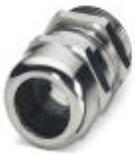
Presse-étoupe, Matériau raccordement vissé: laiton, nickelé, Diamètre extérieur du câble 13 mm ... 18 mm, Blindage: oui, Filetage de raccordement: Pg21, Coloris: argenté
