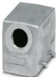
Capot passe-câble B10, pour étrier transversal, Matériau: Aluminium coulé sous pression, résistant à l'eau de mer, Nombre de sorties: 1, latérale, Hauteur: 57 mm, Presse-étoupe: sans, Manchons: non, 1x Pg16, Standard
