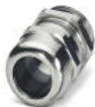
Presse-étoupe, Matériau raccordement vissé: laiton, nickelé, Diamètre extérieur du câble 10 mm ... 14 mm, Blindage: non, Filetage de raccordement: Pg16, Coloris: argenté
