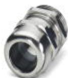
Presse-étoupe, Matériau raccordement vissé: laiton, nickelé, Diamètre extérieur du câble 10 mm ... 14 mm, Blindage: non, Filetage de raccordement: Pg16, Coloris: argenté
