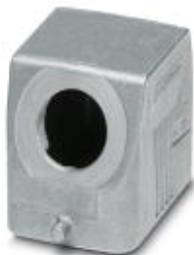
Capot passe-câble B6, pour étrier longitudinal, Matériau: Aluminium coulé sous pression, résistant à l'eau de mer, Nombre de sorties: 1, latérale, Hauteur: 52 mm, Presse-étoupe: sans, Manchons: non, 1x Pg13,5, Standard
