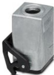
Boîtier prolongateur B6, avec étrier longitudinal, Matériau: Aluminium coulé sous pression, résistant à l'eau de mer, Nombre de sorties: 1, droite, Hauteur: 73 mm, Presse-étoupe: sans, Manchons: non, 1x Pg13,5, Standard
