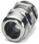
Presse-étoupe, Matériau raccordement vissé: laiton, nickelé, Diamètre extérieur du câble 6 mm ... 12 mm, Blindage: non, Filetage de raccordement: Pg13,5, Coloris: argenté
