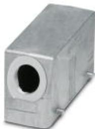
Capot passe-câble B24, pour étrier transversal, Matériau: Aluminium coulé sous pression, résistant à l'eau de mer, Nombre de sorties: 1, latérale, Hauteur: 60 mm, Presse-étoupe: sans, Manchons: non, 1x Pg21, Standard
