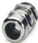
Presse-étoupe, Matériau raccordement vissé: laiton, nickelé, Diamètre extérieur du câble 13 mm ... 18 mm, Blindage: oui, Filetage de raccordement: Pg21, Coloris: argenté
