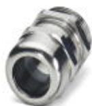
Presse-étoupe, Matériau raccordement vissé: laiton, nickelé, Diamètre extérieur du câble 13 mm ... 18 mm, Blindage: non, Filetage de raccordement: Pg21, Coloris: argenté
