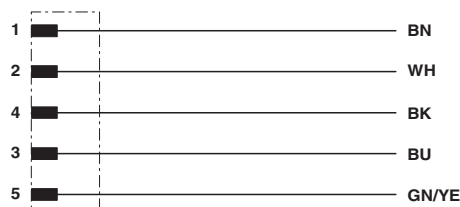
Affectation des contacts du connecteur mâle M12
