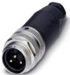
Connecteur, 3-pôles, Connecteur droite 7/8"-16UNF, Raccordement vissé, Matériau de la molette: Zinc moulé sous pression, nickelé, Presse-étoupe Pg9, Diamètre extérieur du câble 6 mm ... 8 mm, Contact 1 à fermeture
