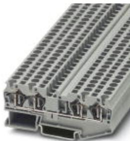
Blocs de jonction simple, Mode de raccordement: Raccordement à ressort, section :0,08 mm<sup>2</sup> - 6 mm<sup>2</sup>, AWG: 28 - 10, Largeur: 6,2 mm, Coloris: gris, Type de montage: NS 35/7,5, NS 35/15
